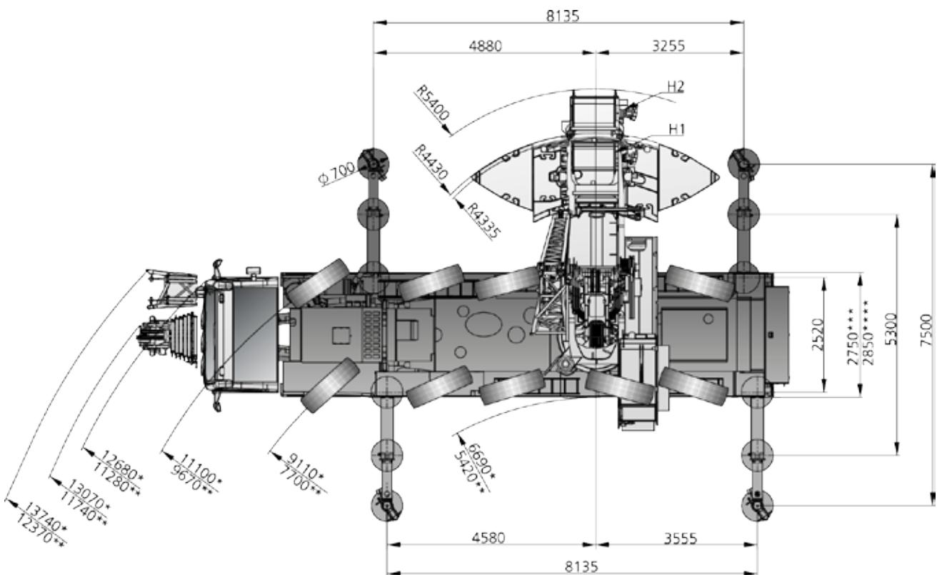
\* steering mode 2 · Lenkfunktion 2 · mode de direction 2 · modalità di sterzata 2 · modo de conducción 2 · modo de manobra 2 · Режим поворота 2
